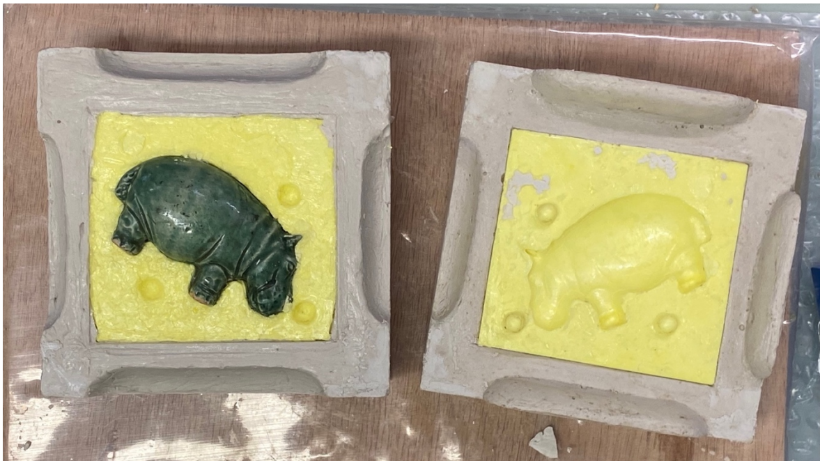
Abb. 116: Mit einem Spachtel wurde die Trennung der Form etwas forciert.
