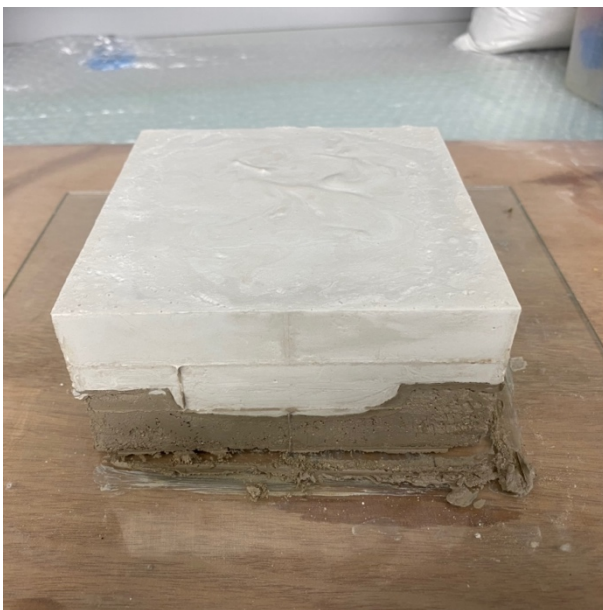
Abb. 108: Nach dem Entfernen des Gussrahmens. Fertig gegossene obere Formhälfte auf der Tonform.
