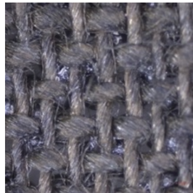
Abb. 91: Saratech® Aktivkohlegewebe bei 150facher Vergrößerung.
