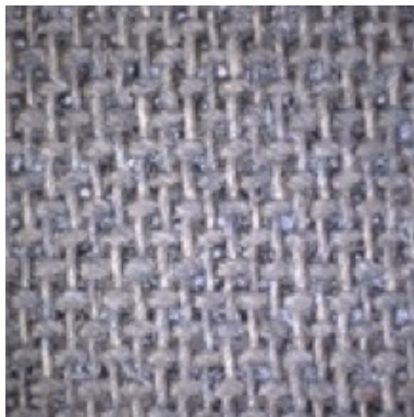
Abb. 90: Saratech® Aktivkohlegewebe bei 50facher Vergrößerung.
