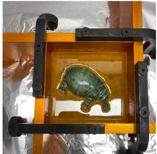
Abb. 99: Der erste Guss reichte nicht aus und es musste erneut Schwefel geschmolzen werden, um auch den Rest der Figur abzugießen.
