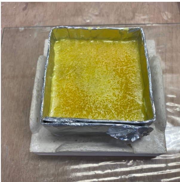
Abb. 112: Der Frisch gegossene Schwefel der zweiten Hälfte.
