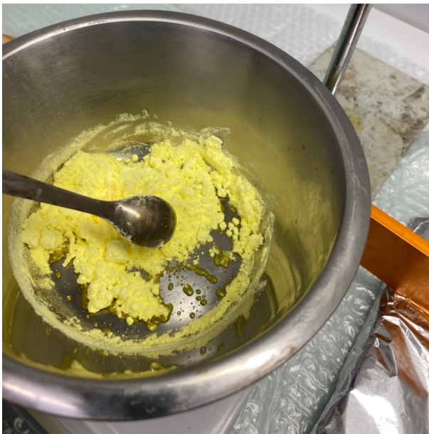
Abb. 96: Ab einer Temperatur von ca. 118°C begann der Schwefel zu schmelzen.
