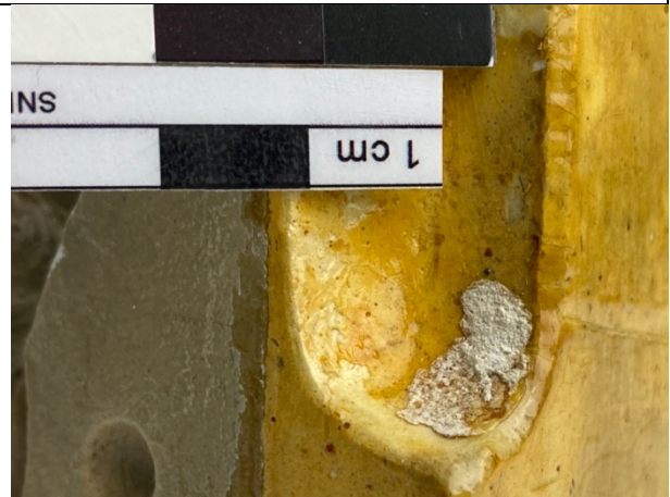
Abb. 53: Anhaftende Gipsscholle in der Vertiefung des Gipsschlusses der Klappform LM-97531.
