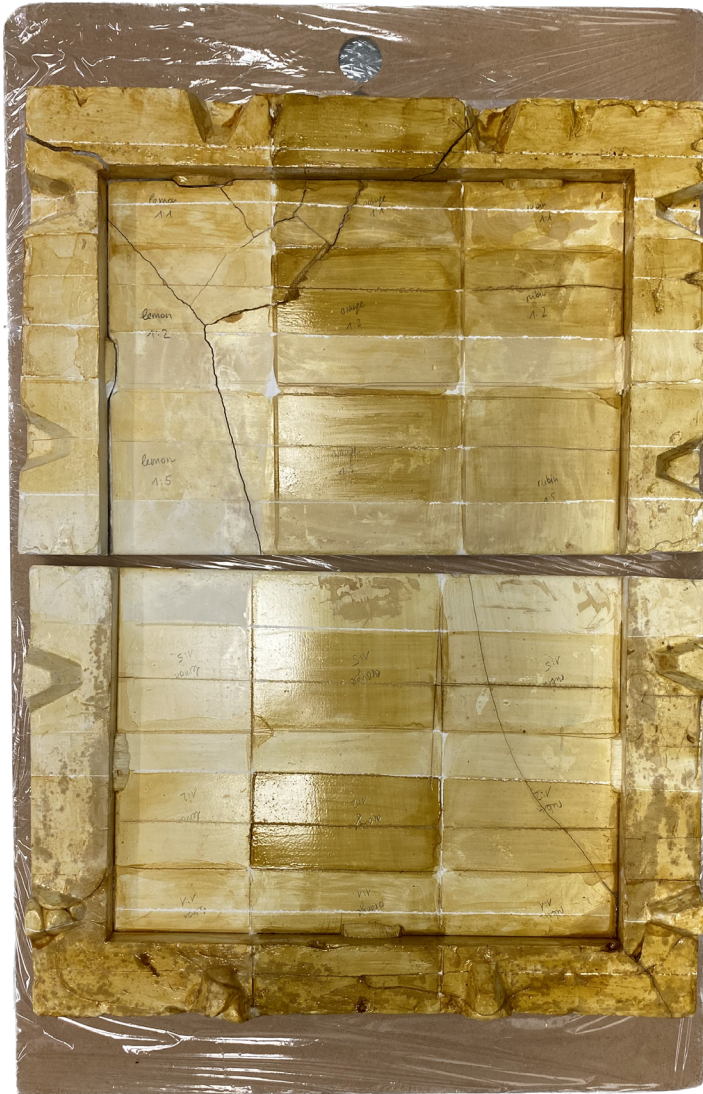
Abb. 120: Test von verschiedenen Schellackschichtdicken und Konzentrationen.
