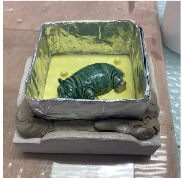
Abb. 111: Für die zweite Hälfte der Schwefelform wird aus Karton, Alufolie und weichem Ton ein Gussrahmen auf die Grösse der bereits gegossenen Schwefelform angepasst. Der bereits gegossene Schwefel muss dick mit einem Trennmittel bestrichen werden
