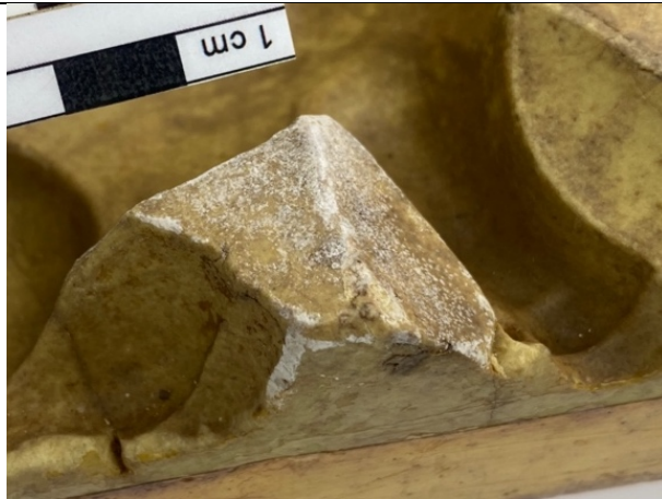
Abb. 42: Weisse, kristalline Ausblühung auf der Klappform LM-97546.
