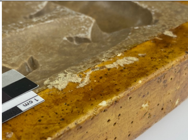
Abb. 14: An dem klebrigen Lack der Form LM-97554 sind Elemente des Verpackungsmaterials kleben geblieben.
