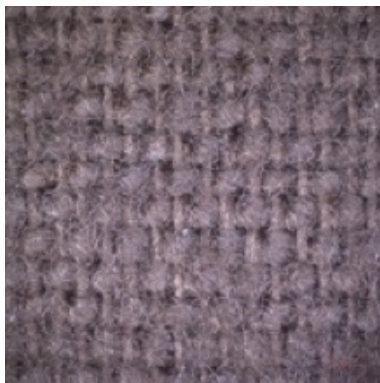
Abb. 88: Silvercloth®, bei 50facher Vergrößerung.
