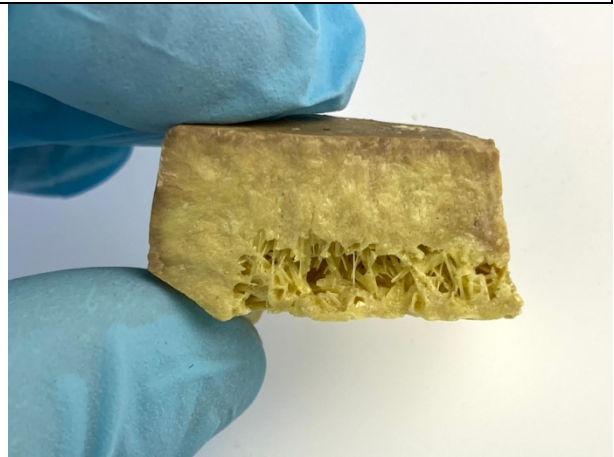
Abb. 39: Bruchstück der Klappform LM-98671. Die oberste Schicht ist bräunlich verfärbt.
