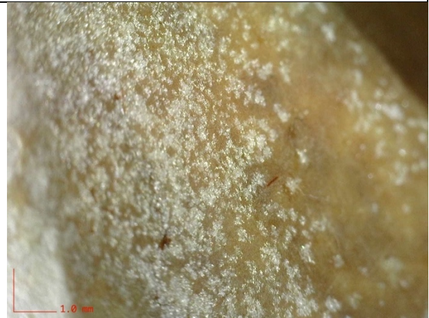
Abb. 43: 40-fache Vergrößerung der kristallinen Ausblühung auf LM-97546 (s. Abb. 42 links), Dino-Lite Universal.
