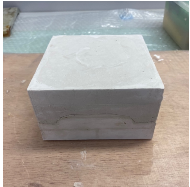
Abb. 115: Sobald auch der Gips der zweiten Hälfte abgebunden hat, kann wiederum der Gussrahmen entfernt werden und die Form getrennt werden.
