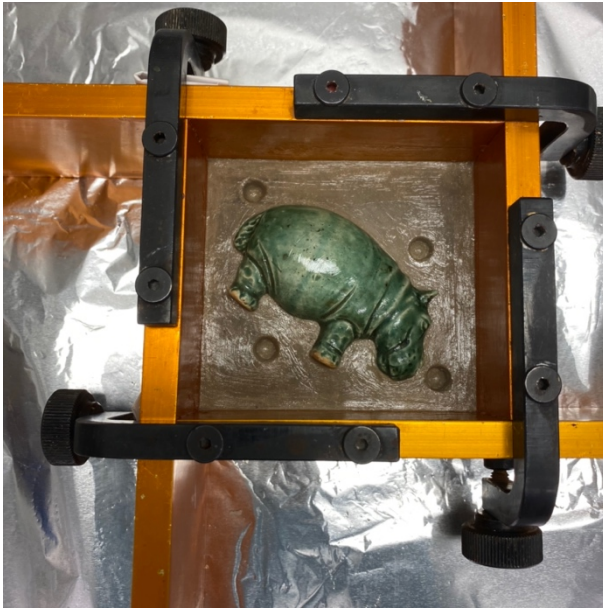
Abb. 94: Auf den Ton und die Figur wurde Vaseline als Trennmittel aufgetragen, um die Form später wieder von dem Guss lösen zu können.
