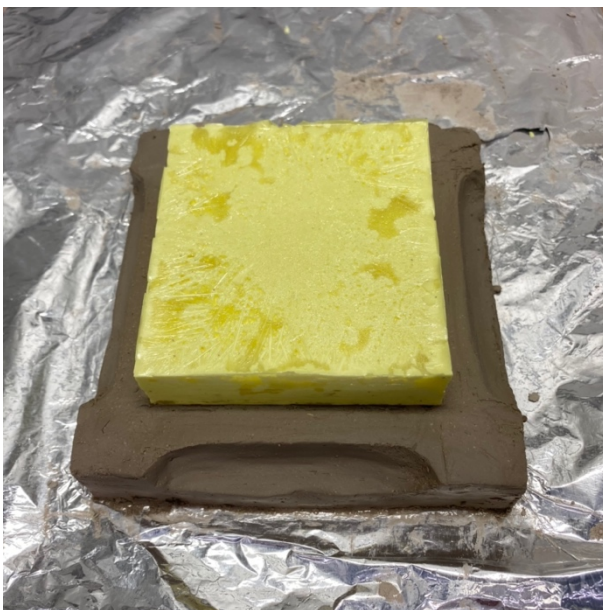
Abb. 104: Im nächsten Schritt soll die Gipskappe um die erste Schwefelformhälfte gegossen werden.
