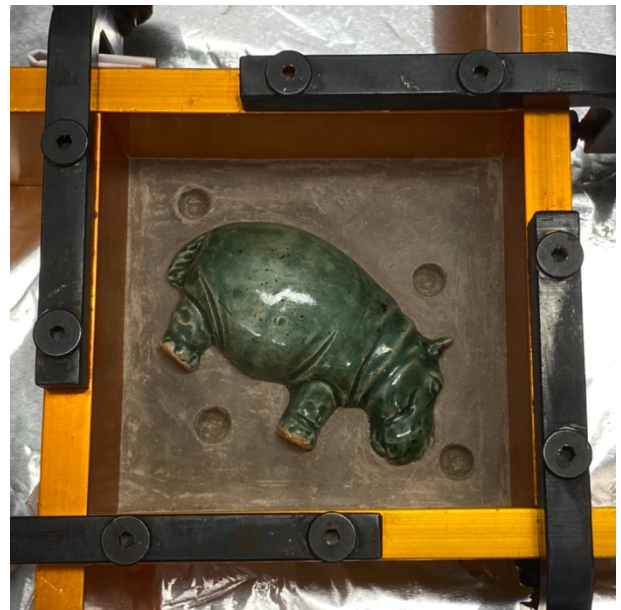
Abb. 93: In einem weiteren Schritt wurde der Ton mit einem Formenrahmen umgeben und mit Schlicker eingepasst, so dass keine Lücken zwischen Ton und Formenrahmen bestehen.
