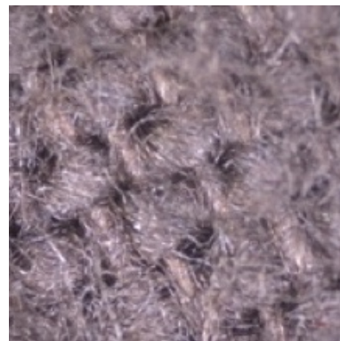
Abb. 89: Silvercloth®, bei 150facher Vergrößerung.
