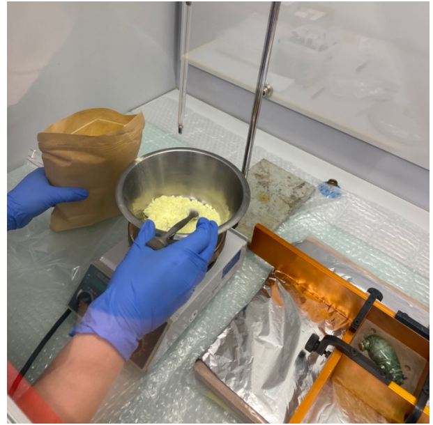
Abb. 95: Auf einer Heizplatte unter dem Laborabzug (Kapelle), wurde der gemahlene Schwefel langsam erwärmt.
