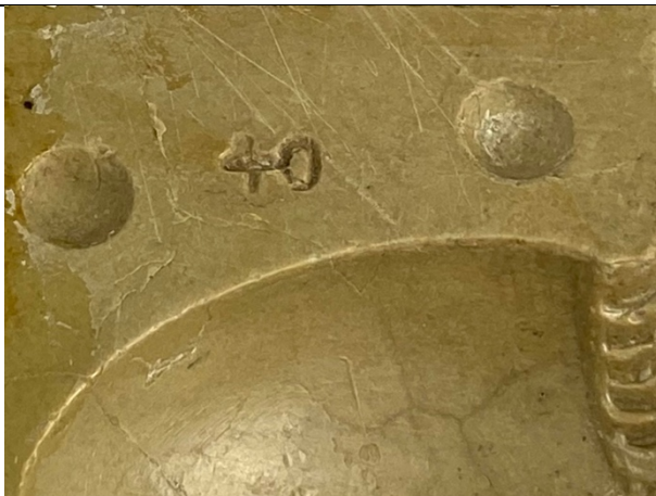
Abb. 36: Kratzer auf der Schwefelform LM-97544.
