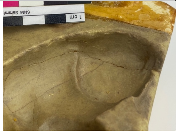
Abb. 19: LM-97532, Risse im polymerisierten Schwefel.
