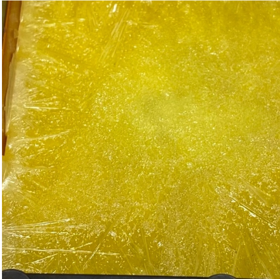
Abb. 3: Frisch gegossener Schwefel. Der Schwefel ist bereits wieder fest und es haben sich auf der Oberfläche lange, nadelartige Kristalle gebildet.
