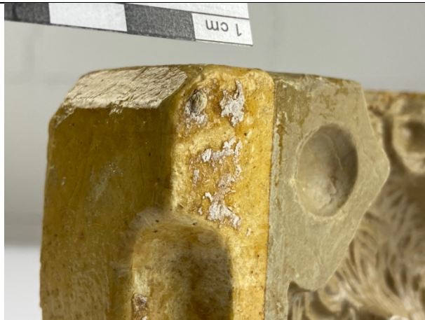
Abb. 16: Der klebrige Lack der Klappform LM-97536 glänzt stark. An ihm bleiben Gips- und Lackschollen der zweiten Hälfte der Klappform kleben.
