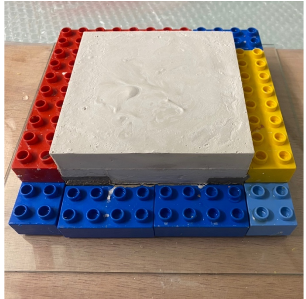
Abb. 107: Nach dem Abbinden des Gipses kann der Gussrahmen entfernt werden.
